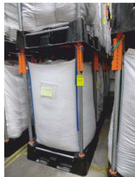
La stabilità e la solidità sono state migliorate grazie a delle nervature e ad un rinforzo in metallo della struttura inferiore.
